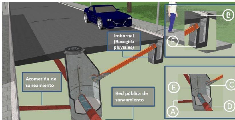
Es necesario probar todos los elementos de la red de saneamiento, es decir tubería, pozos de registro, arquetas y las uniones de los mismos tubo-tubo o pozo-tubo o tubo-arqueta, aunque las tuberías vengan probadas de fábrica es necesario probar la unión entre ellas, la tubería ha podido dañarse durante el transporte o la instalación.
